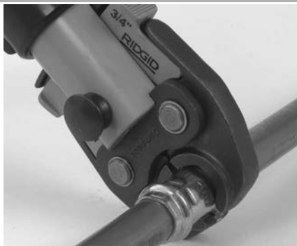
Рис. 7 – Установка пресс-клещей ножничного типа вокруг фитинга
