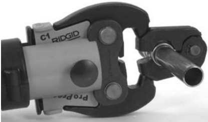
Рис. 10 – Крепление рабочей насадки на обжимном кольце
